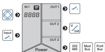
Typ OM 502T je precizní 5místný panelový nastavitelný zobrazovač pro tentometrické snímače doplněný o vážní funkce.
