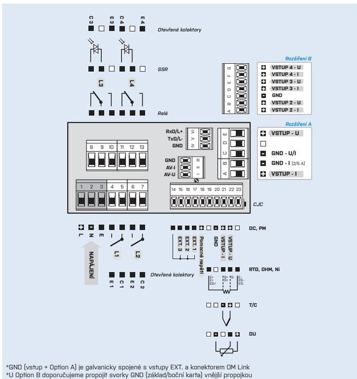
\*GND (vstup + Option A) je galvanicky spojený s vstupy EXT. a konektorem OM Link
