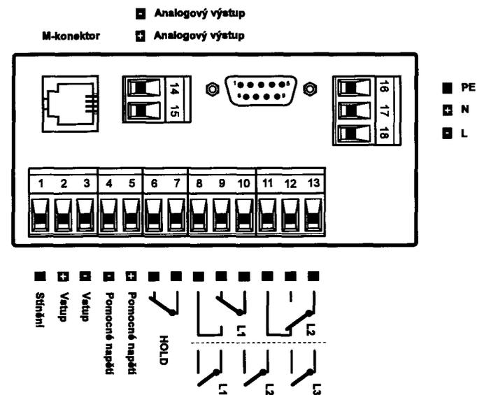
Při nastavení fce "Měření špičkové hodnoty" slouží vstup Hold zároveň pro nulování displeje.
