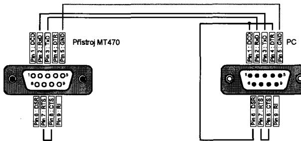
ÚPLNÝ PROPOJOVACÍ KABEL
