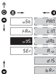
V tomto menu se nastavují parametry výstupních signálů přístroje
