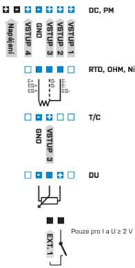
Přívodní vedení pro napájení přístroje by neměly být v blízkosti vstupních nízkonapěťových signálů. Stýkače, motory s větším příkonem a jiné výkonné prvky by neměly být v blízkosti přístroje. Vedení do vstupu přístroje (měřená veličina) by mělo být dostatečně vzdáleno od všech silových vedení a spotřebičů. Přístroje jsou testovány podle norem pro použití v průmyslové oblasti, ale i přesto Vám doporučujeme dodržovat výše uvedené zásady.
