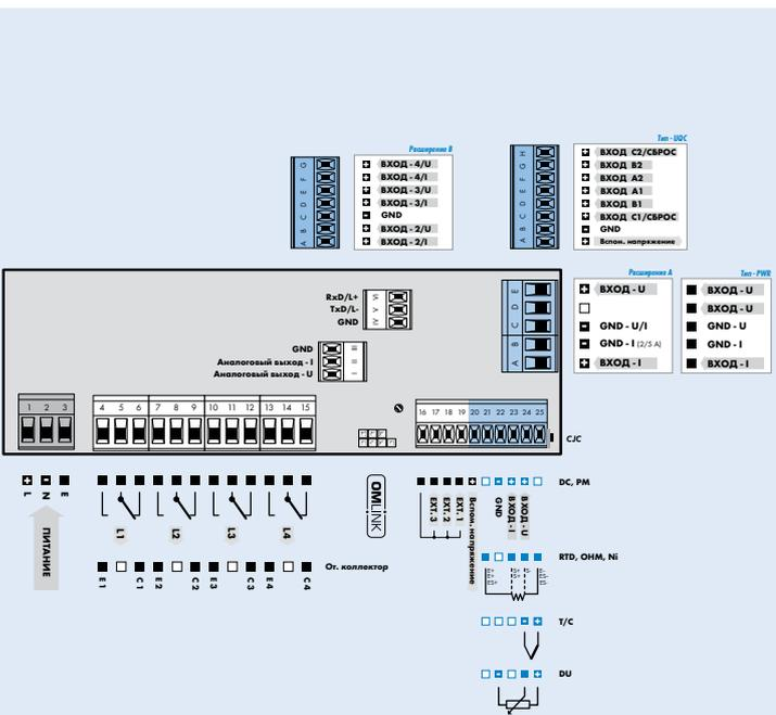
\*GND (Опция A) гальванически соединён с входами EXT и разъемом OM Link
