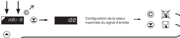
**MAX A** Configuration de l'affichage pour La valeur maximale du signal d'entrée
