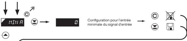
**MIN A** Configuration de l'affichage pour La valeur maximale du signal d'entrée
