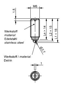
Empfohlener Arbeitspunkt bei Verwendung mit LFP bis L2 =15mm --> 2N recommended working point for use with LFP up to L2 =15mm --> 2N
