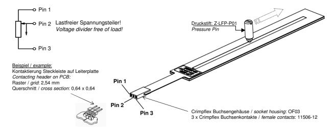
Die Pin-Belegung für die fallende bzw. steigende Kennlinie ist bei dargestellter Bewegungsrichtung des Druckstiftes gültig! The pin assignment for the falling or rising characteristic is valid for illustrated direction of pressure pin!
