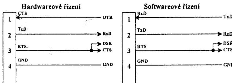
Propojení po RS485/422 s nadřazeným systémem se provede následujícím způsobem
