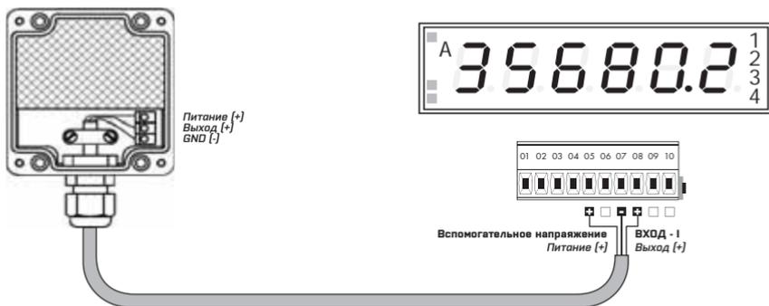
Пример подключения трехпроводного датчика с выходом по-напряжению, питающегося от прибора
