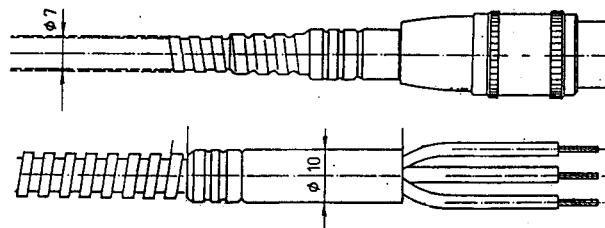
Zakončení kabelu s mechanickou ochranou, volnými konci nebo konektorem
