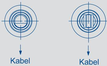
Zeigt die Wellenmarkierung in Richtung Anschlusskabel, dann befindet sich der Sensor auf Kennlinienmitte.
